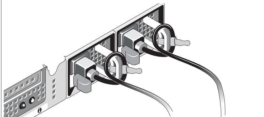
Připevněte retenční svorku napájecího kabelu do pravého ohybu rukojeti napájecího zdroje. Udělejte na napájecím kabelu smyčku, jak je znázorněno na obrázku, a připevněte ho do příslušného úchytu.
