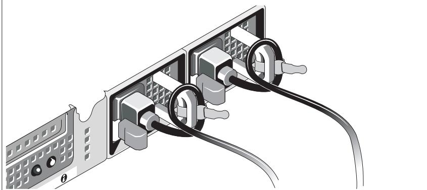
Bringen Sie die Halteklammer für das Netzkabel am rechten Bogen des Netzteilgriffs an. Biegen Sie das Netzkabel wie abgebildet zu einer Schlaufe und befestigen Sie es an der Kabelklemme der Halteklammer.
