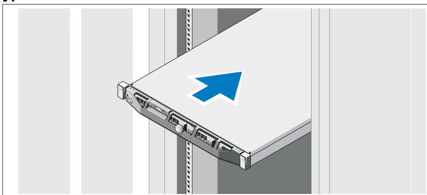
Zamontuj prowadnice i zainstaluj zestaw komputerowy w szafie typu rack zgodnie z instrukcjami dotyczącymi bezpieczeństwa oraz instrukcjami dotyczącymi instalacji szafy typu rack dostarczonymi wraz z zestawem komputerowym.
