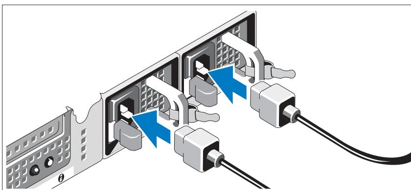
Schließen Sie das/die System-Netzstromkabel an das System an. Falls ein Bildschirm verwendet wird, schließen Sie auch hier das zugehörige Netzstromkabel an.
