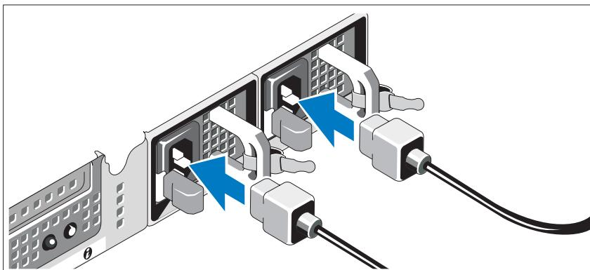
Připojte napájecí kably k systému, a pokud používáte monitor, připojte napájecí kabel také k monitoru.
