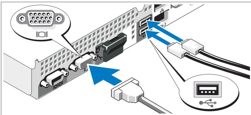
Подключите клавиатуру, мышь и монитор (дополнительно).
