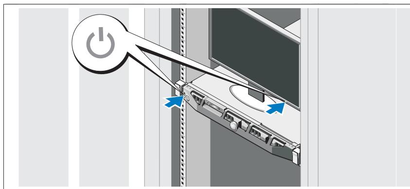
Sistem ve monitör üzerindeki güç düğmesine basın. Güç göstergeleri yanmalıdır.
