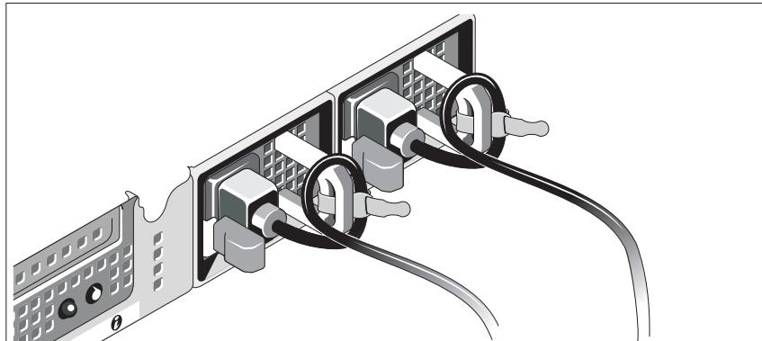
Podłącz wspornik podtrzymujący kabel zasilania do prawego węzła na uchwycie zasilacza. Utwórz na kablu zasilacza pętlę w taki sposób, jak pokazano na ilustracji i przymocuj ją do zacisku kabla na wsporniku.
