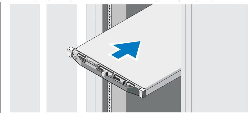
Συναρμολογήστε τις ράγες και τοποθετήστε το σύστημα στο ράφι, σύμφωνα με τις οδηγίες ασφαλείας και τις οδηγίες τοποθέτησης σε ράφι που συνοδεύουν το σύστημά σας.
